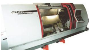
CNC-Drehen bis 2 m mit 4 Achsen und angetriebenen Werkzeugen
